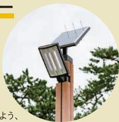
災害時に停電した際も避難場所とわかり、活動ができるよう、太陽光をエネルギーにした照明を導入。景観に配慮し、照明の外側部分は再生木材を使っています。
